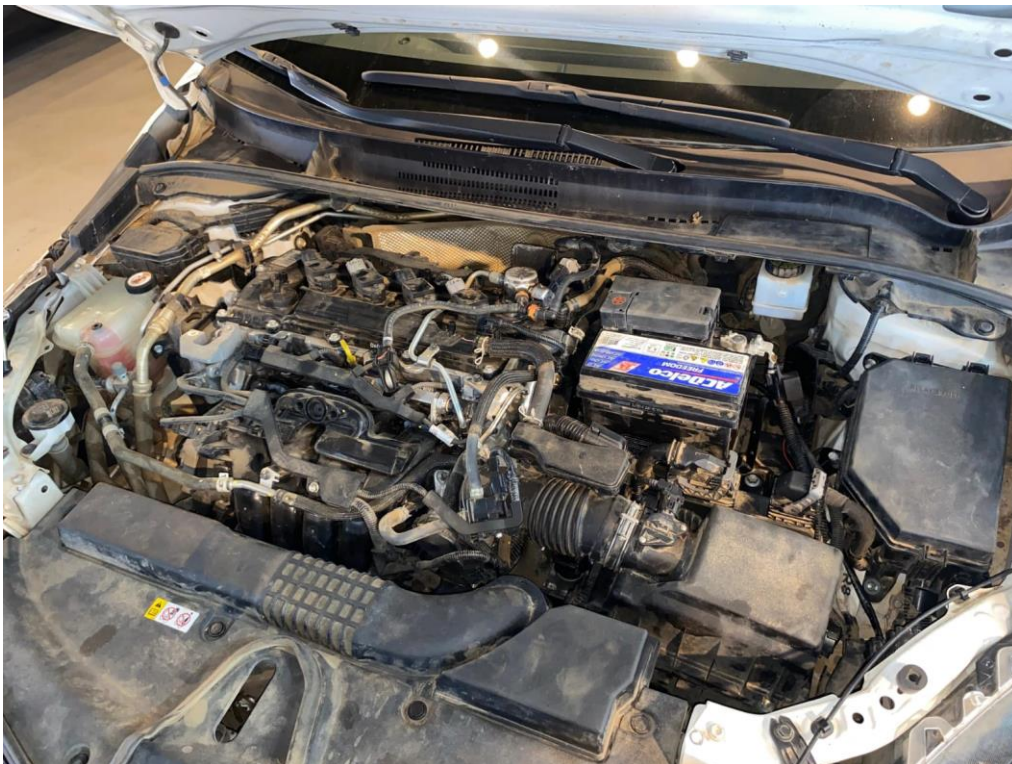
FIGURA 10 – Motor com transmissão montada
